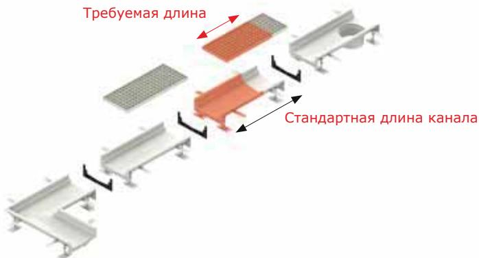
Укажите необходимую длину канала (в случае если вы используете канал с уклоном дна, длина измеряется от более глубокой части канала)
